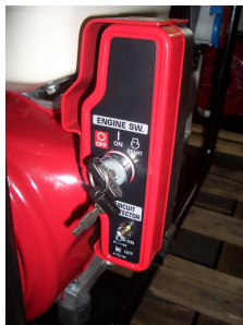
HONDA STARTNØGLE (ELECTRISK VERSION) HVIS UDSTYRET MED AUTOMATISK PANEL, SKAL NØGLEN ALTID STÅ I "ON" -POSITION
