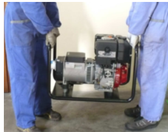
Fig. 7.2: Løft af generatoranlægget med løftkroge eller manuelt af operatører
