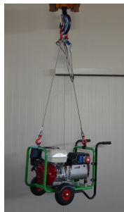
Fig. 7.2: Løft af generatoranlægget med løftkroge eller manuelt af operatører
